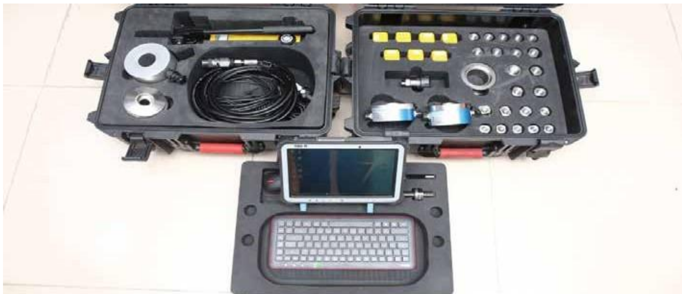
MÁY THỬ VAN AN TOÀN ONLINE Online safety valve testing machine
