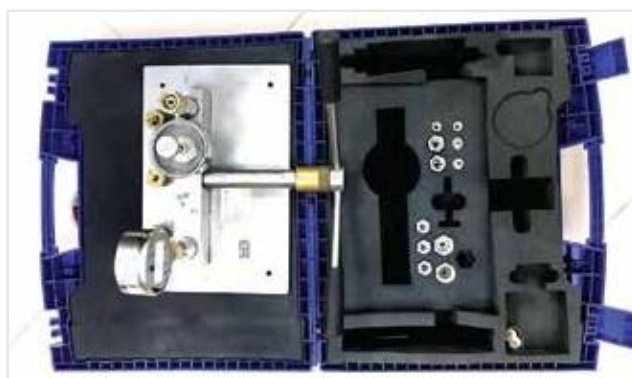
BÀN TẠO ÁP Pressure generating table
