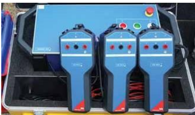
THIẾT BỊ CHỤP SÓNG MÁY CẮT Cutting machine wave recording equipment
