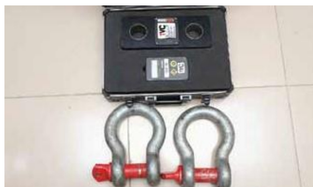
LỰC KẾ 25 TẤN 25-ton dynamometer
