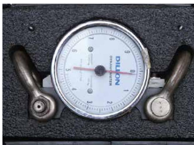
LỰC KẾ CƠ 10 TẤN 10-ton mechanical dynamometer
