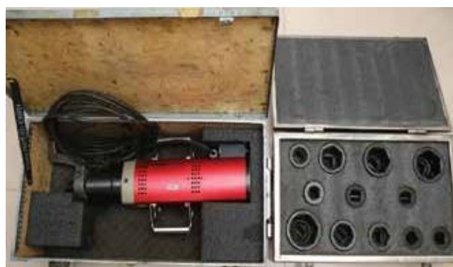
THIẾT BỊ KIỂM TRA LỰC XIẾT BULÔNG Bolt tightening force testing tool
