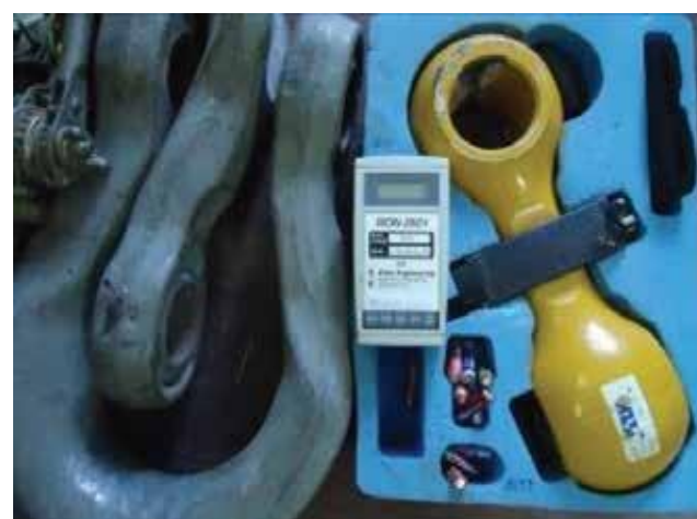
LỰC KẾ ĐIỆN TỬ 125 TẤN 125-ton electronic dynamometer
