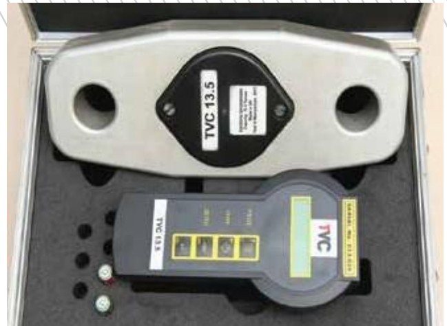
LỰC KẾ ĐIỆN TỬ Electronic dynamometer
