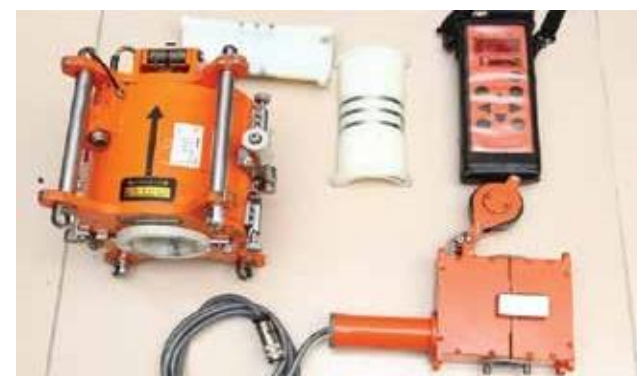
MÁY KIỂM TRA CÁP THÉP Steel cable inspection tool
