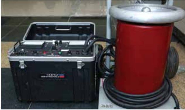
BỘ THỬ CAO ÁP 100 KV 100kV high voltage testing equipment
