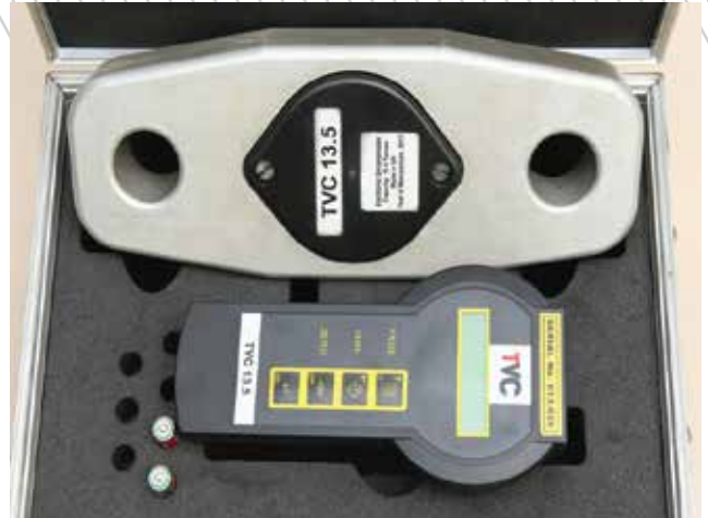
LỰC KẾ ĐIỆN TỬ Electronic dynamometer
