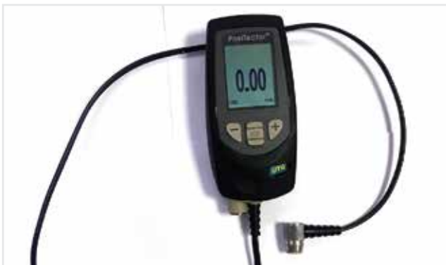
MÁY SIÊU ÂM CHIỀU DÀY Ultrasonic depth measuring tool
