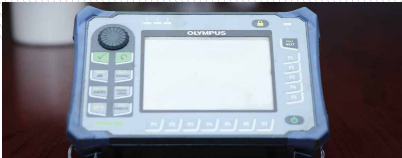
THIẾT BỊ SIÊU ÂM MỐI HÀ Ultrasonic welding inspection tool
