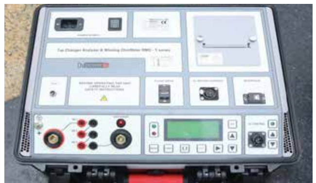
MÁY ĐO ĐIỆN TRỞ MỘT CHIỀU CUỘN DÂY Tap changer analyzer & winding ohmmeter
