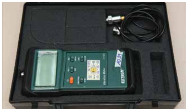
MÁY ĐO ĐỘ RUNG Vibration gauge
