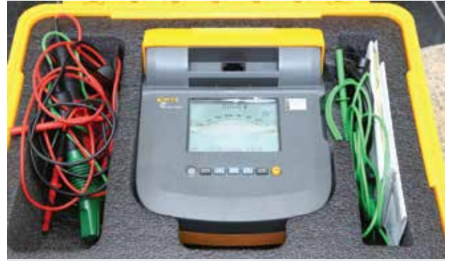
MÁY ĐO ĐIỆN TRỞ CÁCH ĐIỆN Insulation testing machine
